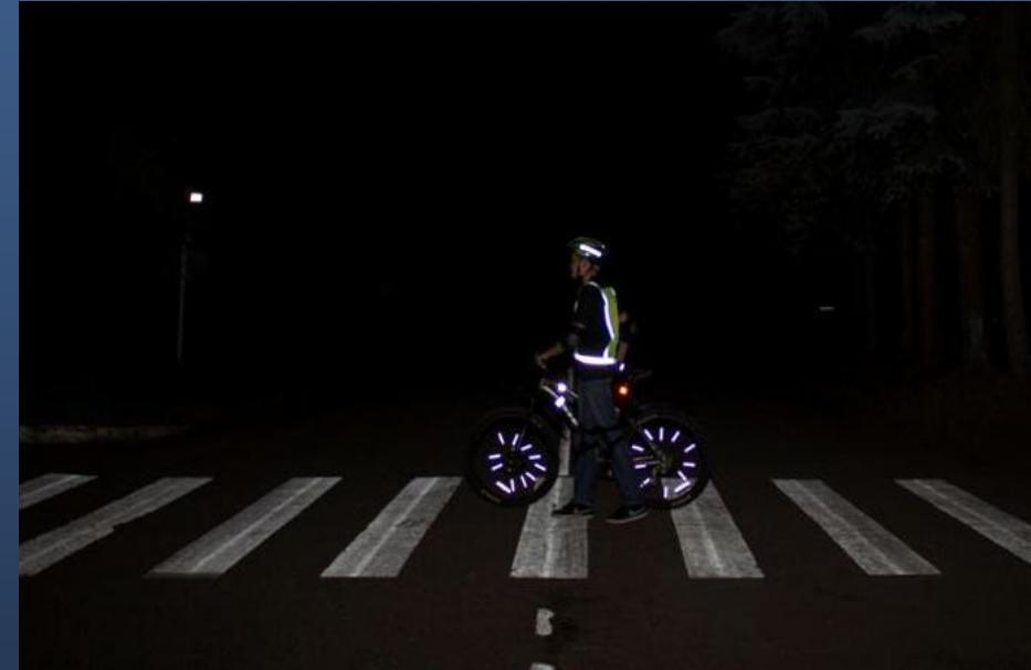
**Выводы:** На приведенных фотографиях хорошо видно, что наличие на велосипеде только стандартных сигнальных средств (катафотов) из-за их малой площади не обеспечивает достаточную заметность в боковой проекции. Использование сигнального световозвращающего жилета и световозвращателей на спицах колес значительно повышает заметность велосипедиста со всех сторон.
